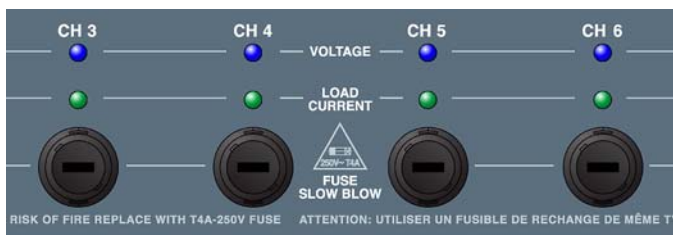
Рисунок 2.4. Индикаторы и плавкие предохранители Stella-4.
