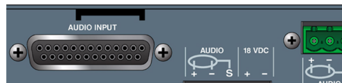
Рисунок 2.6. Сигнальный разъем Stella-188.
